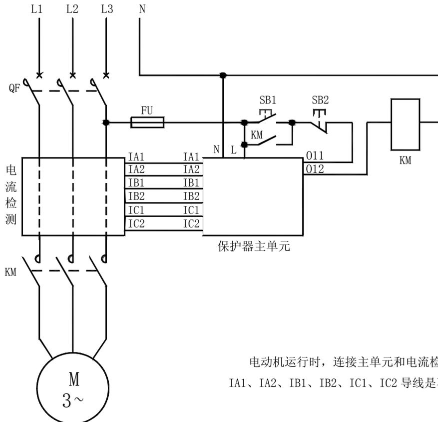
AMDS-□/□ 系列电动机保护器应用电气原理图
