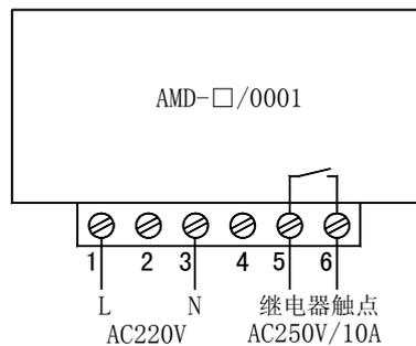
AMD -□/0001 系列电动机保护器接线端子图
