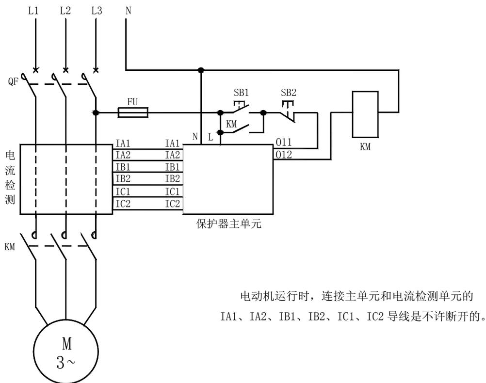
AMDS-□/□ 系列电动机保护器应用电气原理图
