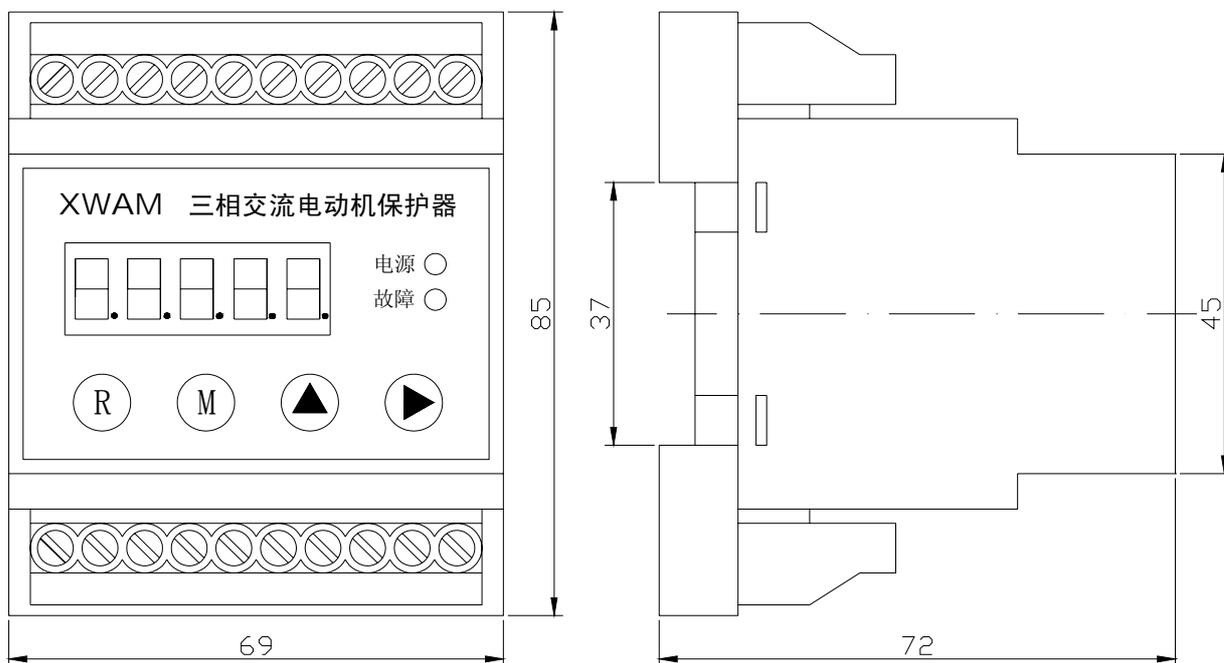
AMDS-□/C 系列电动机保护器主单元外形及安装孔尺寸
