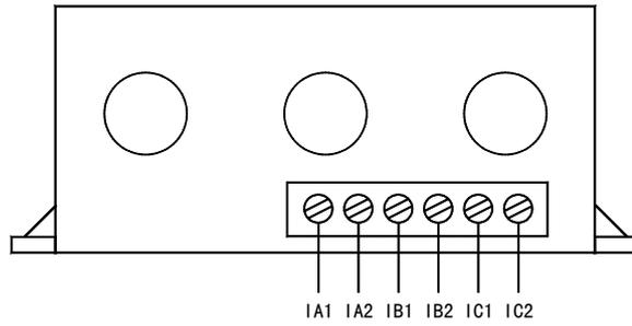
2、AMDG-□/CO1□ 系列电动机保护器主单元接线端子
