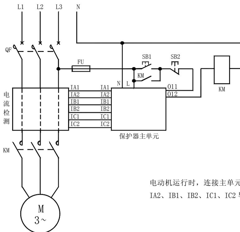
电动机运行时，连接主单元和电流检测单元的 IA1、IA2、IB1、IB2、IC1、IC2 导线是不许断开的。
