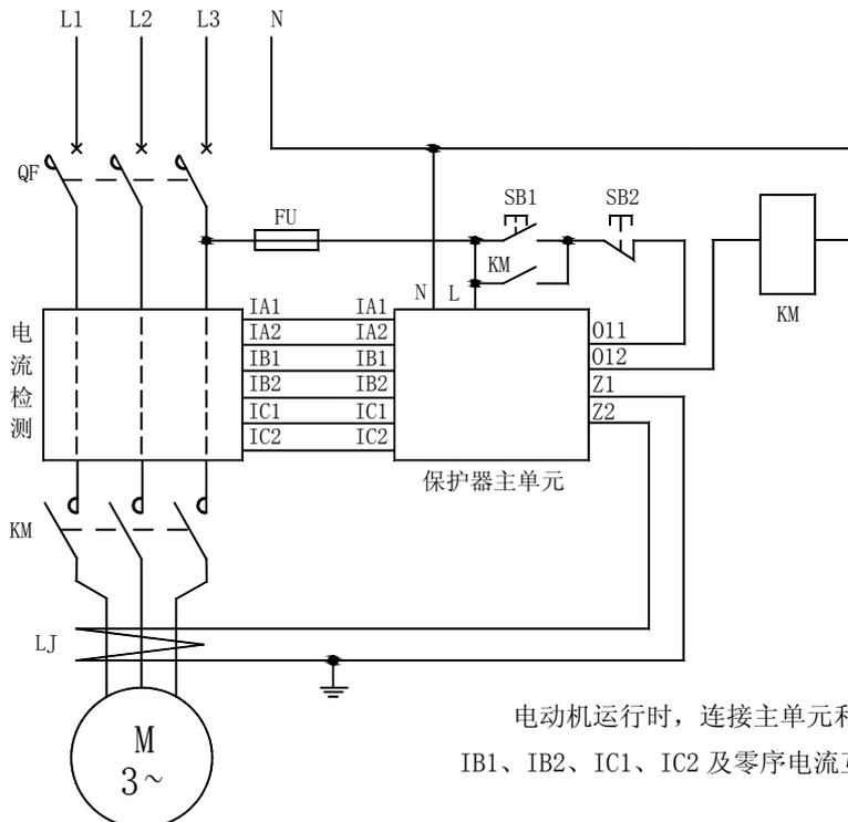
电动机运行时，连接主单元和电流检测单元的 IA1、IA2、IB1、IB2、IC1、IC2 及零序电流互感器的导线是不许断开的。
