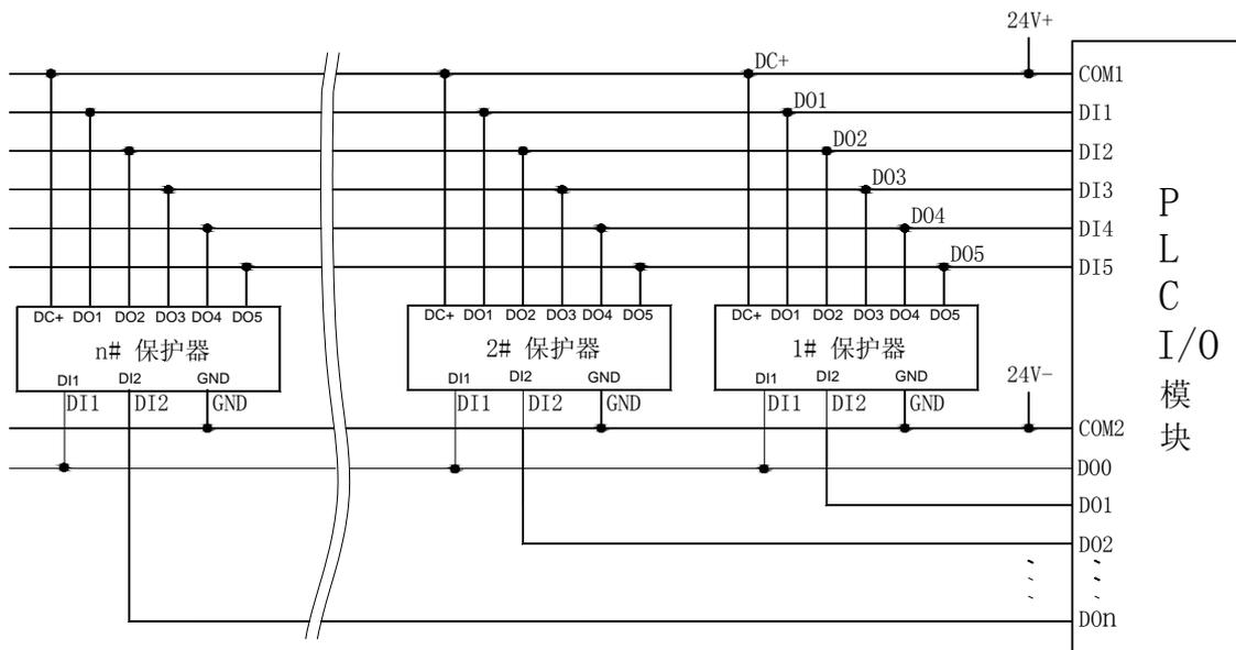
PLC 读取多台 AMDG-□/ D8 系列电动机保护器电气原理图
