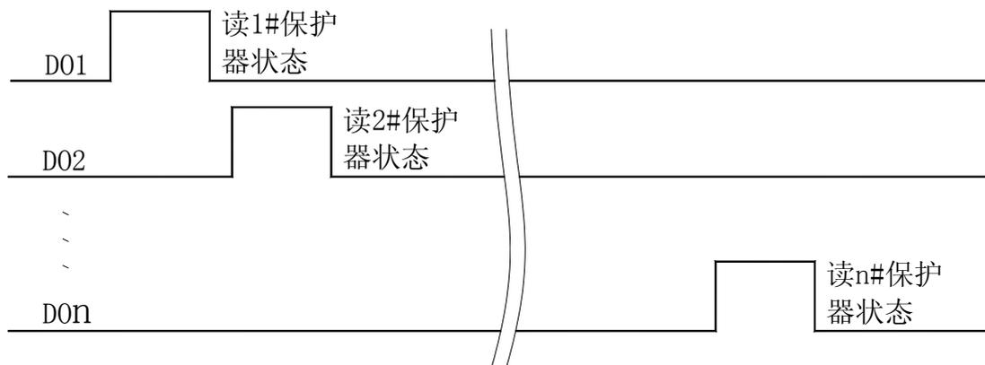
PLC 读取多台 AMDG-□/ D8 系列电动机保护器时序图
