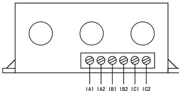
2、AMDG-□/ D8 系列电动机保护器主单元接线端子
