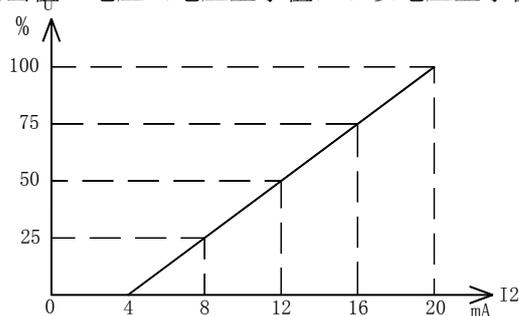
电压的 4-20mA 表示的电压范围
