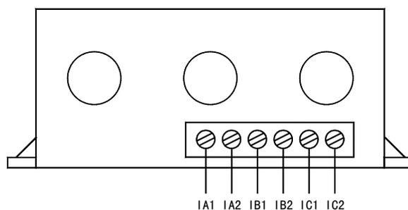
2、AMDP-□/A01□ 系列电动机保护器主单元接线端子
