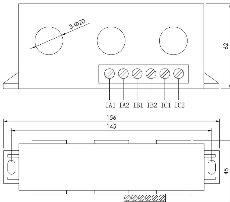
4、穿线孔直径  $\Phi 30\text{mm}$  的电流检测单元外形及安装尺寸
