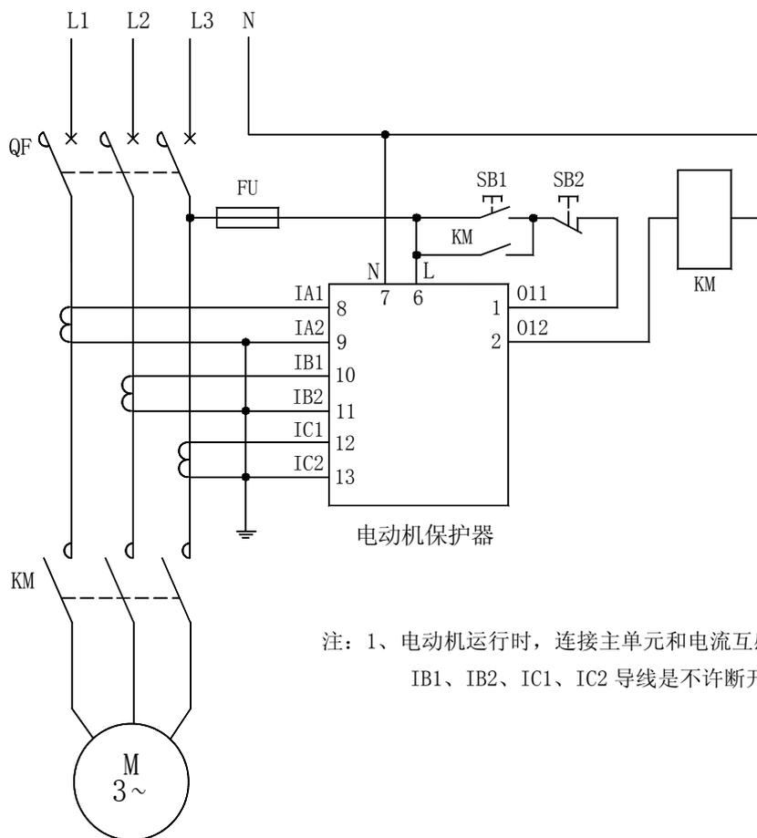
注：1、电动机运行时，连接主单元和电流互感器的 IA1、IA2、IB1、IB2、IC1、IC2 导线是不许断开的。
