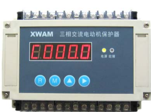
AMDG-□/D0 系列电动机保护器主单元
