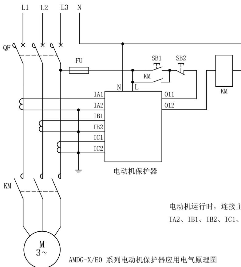
电动机运行时，连接主单元和电流互感器的 IA1、IA2、IB1、IB2、IC1、IC2 导线是不许断开的。
