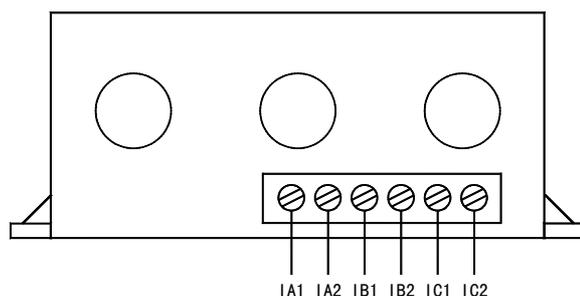
AMDP-□/A0□□ 系列电动机保护器电流检测单元接线端子图
