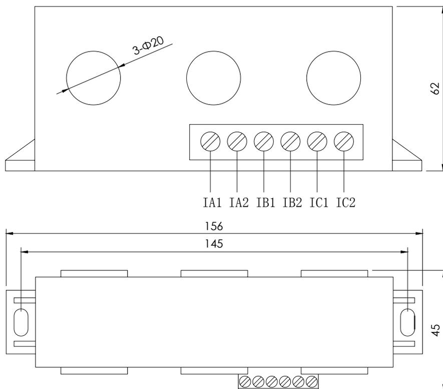
3、穿线孔直径  $\Phi 30\text{mm}$  的电流检测单元外形及安装尺寸
