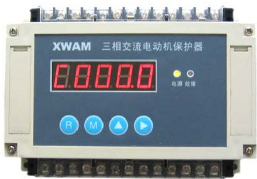
AMDG-□/D0 系列电动机保护器主单元
