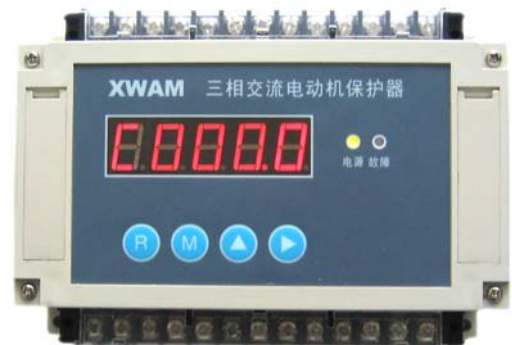
AMDG-X/F7 系列电动机保护器主单元
