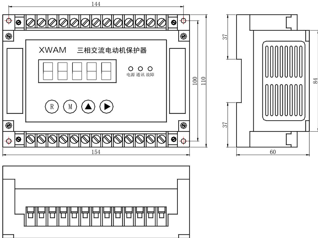
AMDG-□/□/43□ 系列电动机保护器主单元外形及安装孔尺寸
