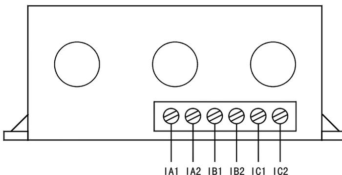
AMDG-□/□D43□ 系列保护器电流检测单元接线端子图
