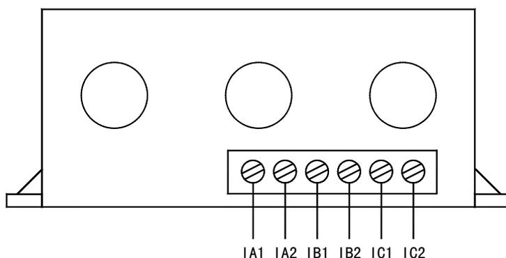
AMDG-□/ D621 系列保护器电流检测单元接线端子图
