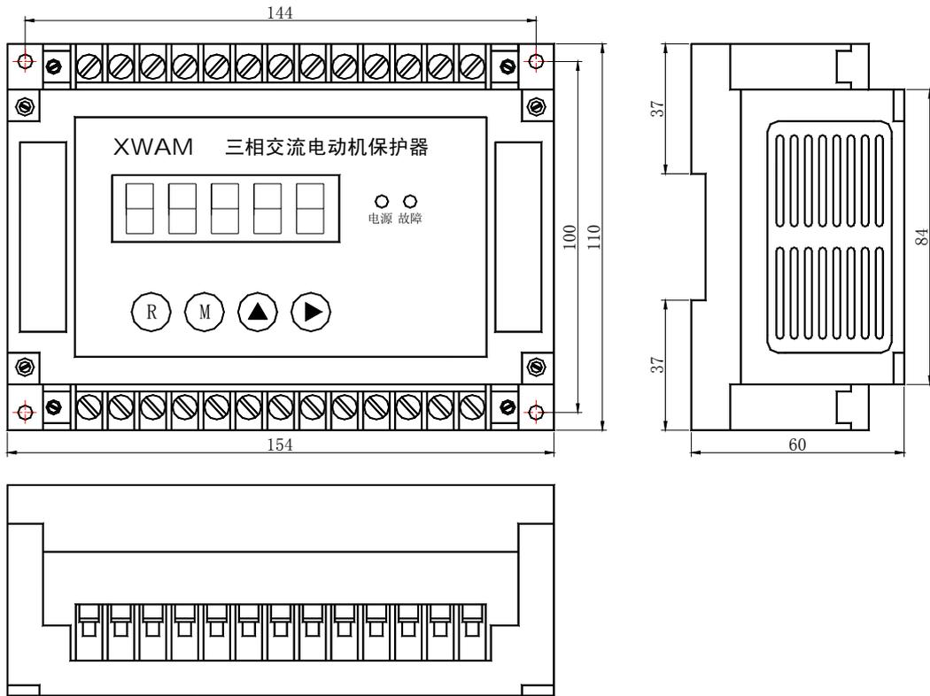
AMDG-□/ D621 系列电动机保护器主单元外形及安装孔尺寸
