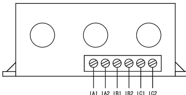
AMDG-□/701 系列保护器电流检测单元接线端子图
