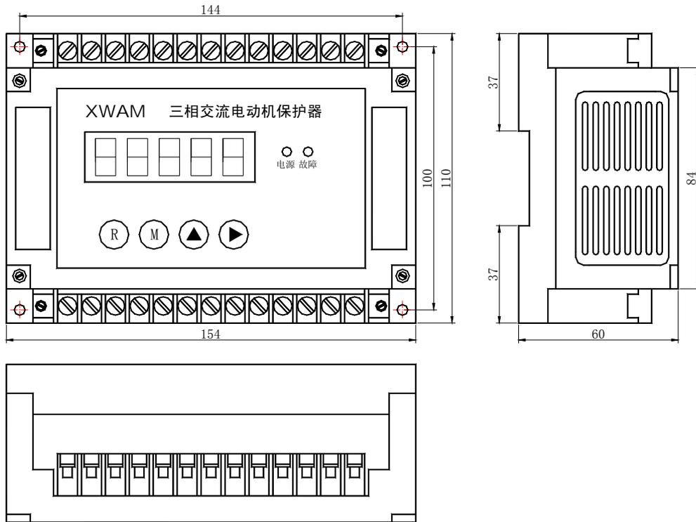
AMDG-□/ D701 系列电动机保护器主单元外形及安装孔尺寸
