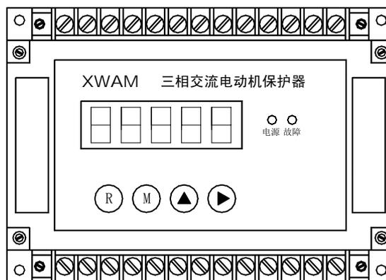
堵转、电流不平衡、过载故障时, 对应的故障类型输出信号 (D01-D06 中的 1 个) 及故障预警输出信号 D07 输出低电平, 当故障持续到设定的报警时间, 继电器触点 011、012 断开停止电动机运行 (故障灯亮), 故障预警 D07 输出高电平, 故障报警输出信号 D08 输出低电平, 保护器显示故障代码指示故障类型, 并且显示电动机发生故障时的 A、B、C 相电流、电压。电动机故障查清、排除后, 采取按复位按钮 R、加清除故障脉冲信号于 DI1、使电动机保护器重新上电中的 1 种方法之后故障状态被
