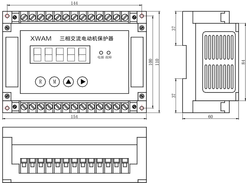
AMDGH-□/ D501 系列电动机保护器主单元外形及安装孔尺寸
