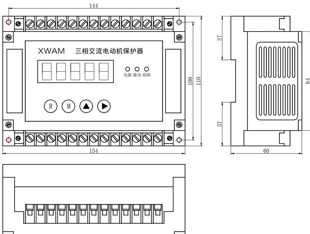
AMDGH-X/F44□ 系列电动机保护器主单元外形及安装孔尺寸
