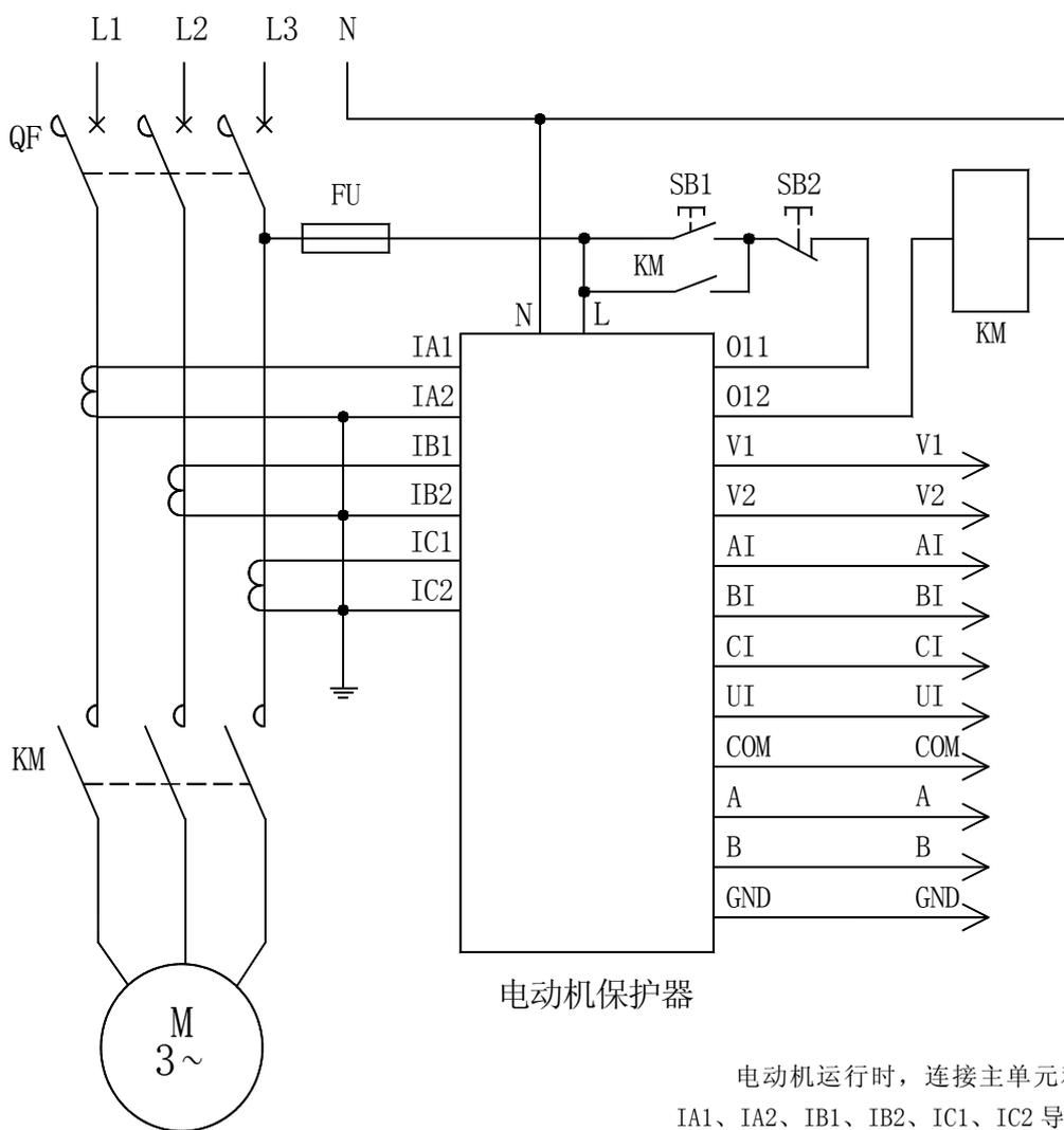
电动机运行时，连接主单元和电流互感器的 IA1、IA2、IB1、IB2、IC1、IC2 导线是不许断开的
