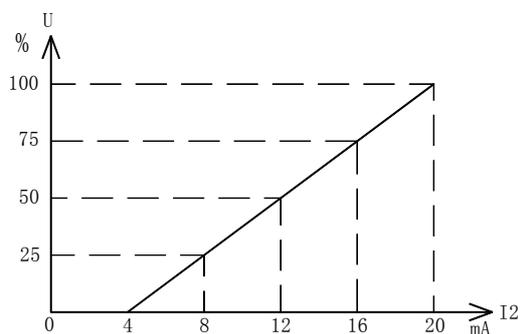
电压的 4-20mA 表示的电压范围
