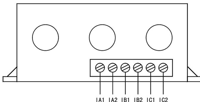
AMDP-□/□A06□ 系列保护器电流检测单元接线端子图
