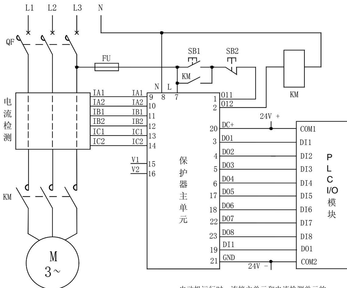
AMDP-□/ D541 系列电动机保护器 D0 连接 PLC 电气原理图
