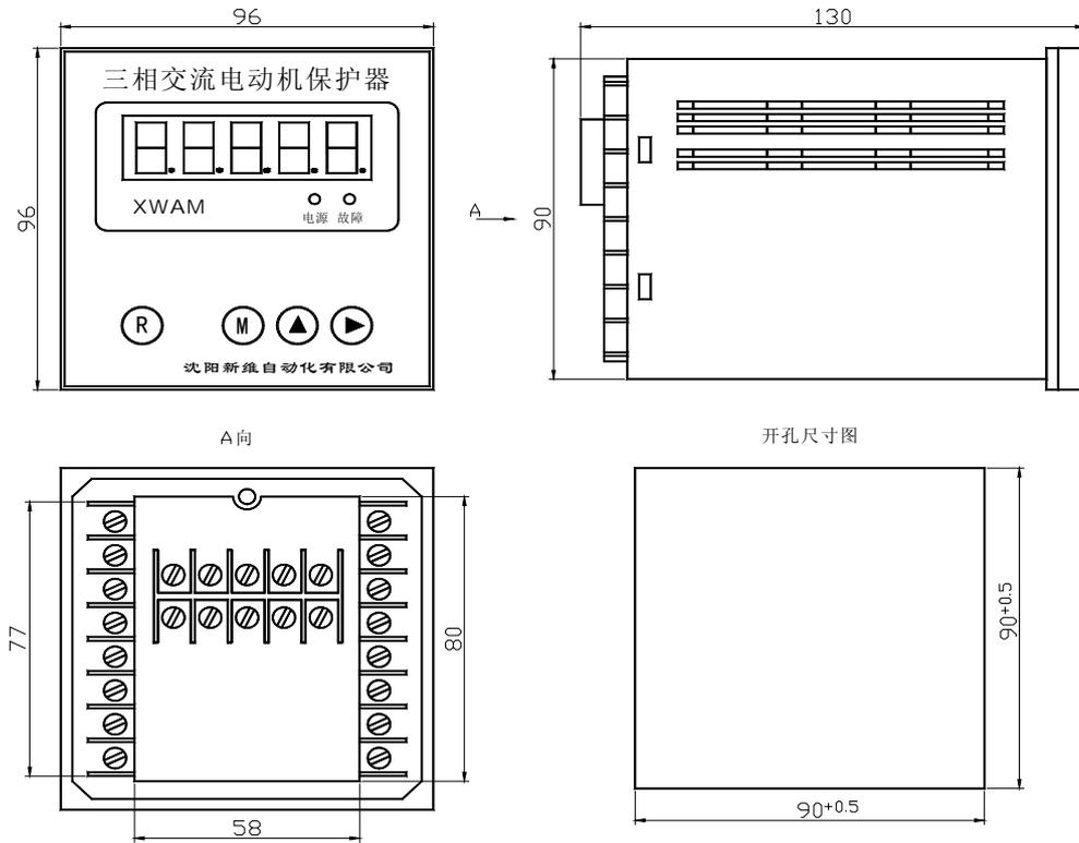
AMDP-□/ D541 系列电动机保护器主单元外形及安装孔尺寸
