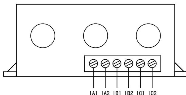
AMDP-□/541 系列保护器电流检测单元接线端子图
