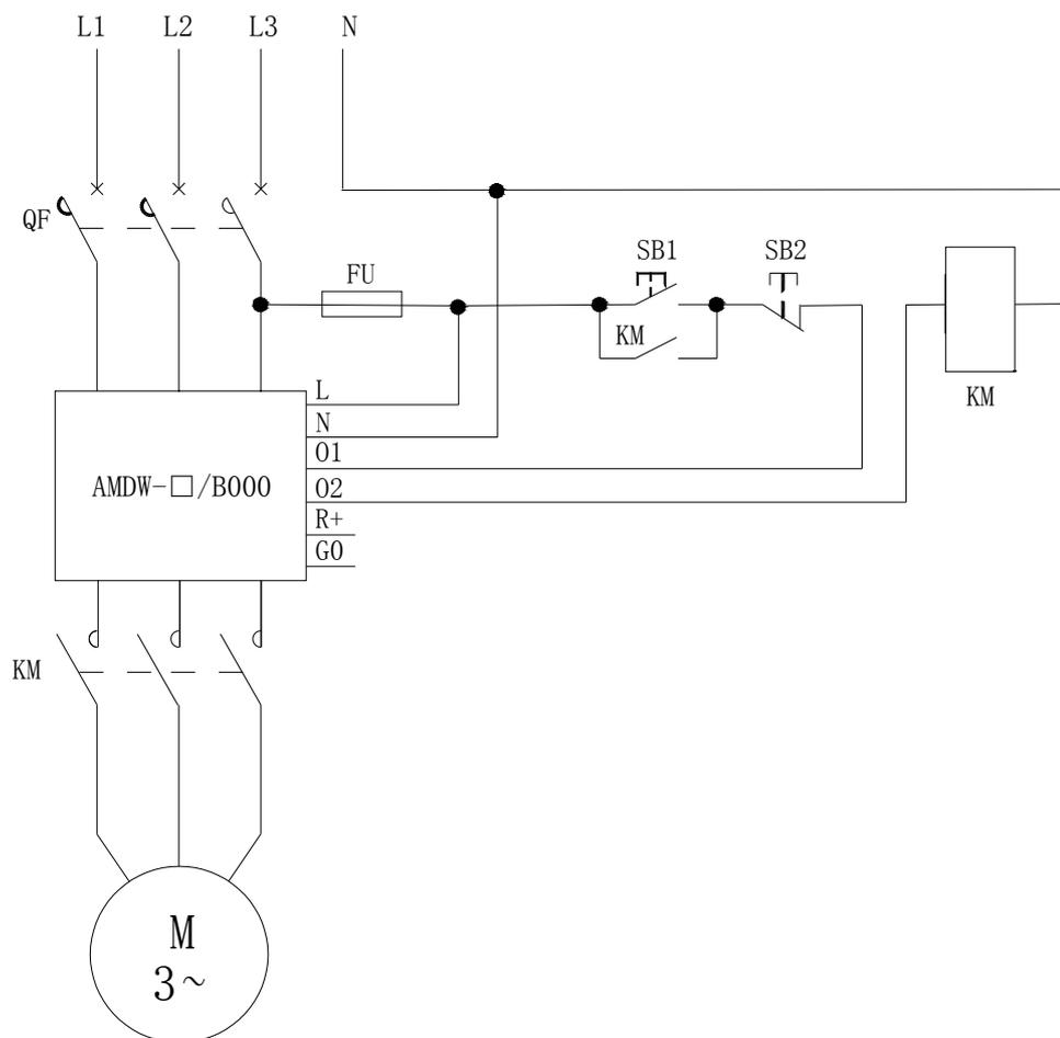
AMDW-□/BO00 系列电动机保护器应用电气原理图
