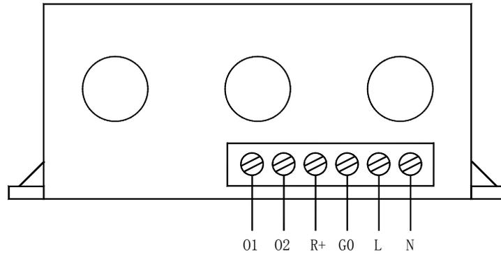
AMDW-□/000 系列电动机保护器接线端子图
